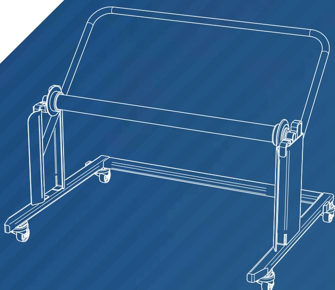
Accessoire indépendant contribuant à limiter le temps de remplacement d'une bobine sur la coupeuse EXCALIBUR®.
